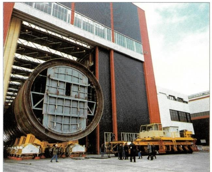
Transfert de la section S 3/4 sur 12 marcheurs entrant dans la nef CA.
