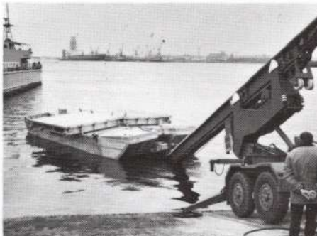
Essais de mise à l'eau sur rampe de pente supérieure à 20 %. Launching trials on a ramp with a slope higher than 20 % Hundimiento sobre rampa superior a 20 %
