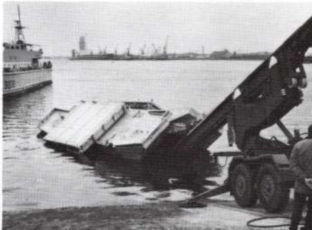
Essais de mise à l'eau sur rampe de pente supérieure à 20 %. Launching trials on a ramp with a slope higher than 20 % Hundimiento sobre rampa superior a 20 %
