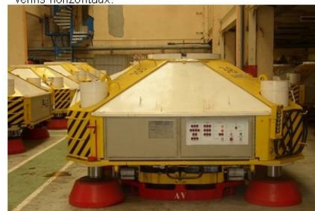
La charge est appuyée sur le pied central dont la partie supérieure roule sur la partie inférieure sous l'effet des vérins horizontaux.
