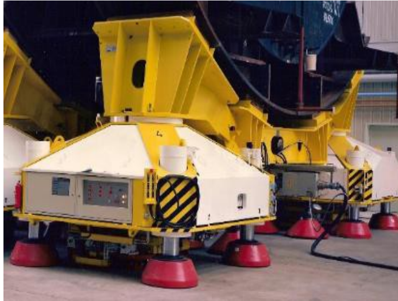
8-© NAVAL GROUPE- Ligne de supportage de 800 t - Support assembly of 800 t
