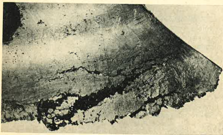
FIG. 1. — Pale d'hélice en acier inoxydable Z 14 CN 18-10. Corrosion intergranulaire généralisée. Document S.T.C.A.N.
