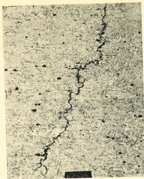
FIG. 2. — Acier Z 5 CN 17-4. Fissure de corrosion sous tension en eau de mer
