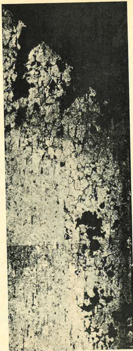
FIG. 8. — Élément semblable à celui de la figure 7, en acier Z 15 CN 16 Même zone que figure 7 C On observe la superposition de la corrosion intergranulaire et de la corrosion caverneuse
