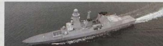
LES FRÉGATES HORIZON SONT ÉQUIPÉES DE MOYENS DE VEILLE ACTIFS ET PASSIFS LEUR PERMETTANT DE DÉTECTER TOUT MOBILE DANS UN RAYON DE 350 KILOMÈTRES ET DE PARTAGER CES INFORMATIONS AVEC LES CENTRES DE COMMANDEMENT ET DE CONTRÔLE À TERRE ET LES AUTRES UNITÉS.
