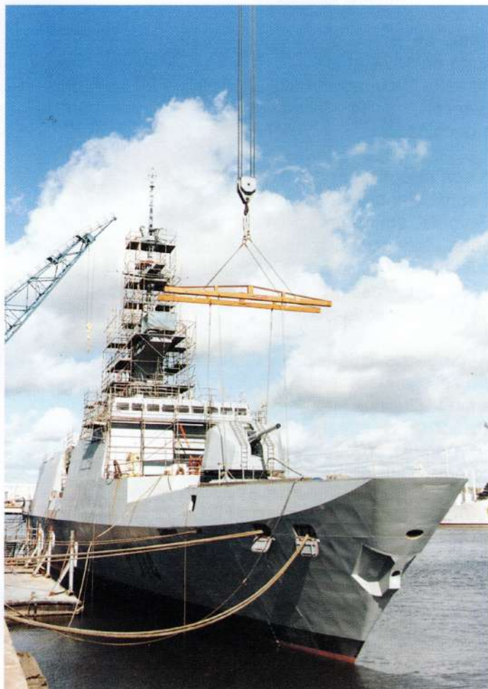
Mise en place de la tourelle de 100 mm le 28/02/2000
